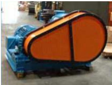
حفاظ گذاری تجهیزات انتقال نیرو
